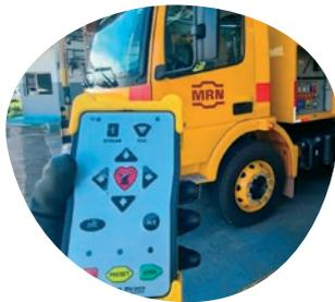
Caminhão de Bombeiros com comando de todas as operações tipo *joystick* na cabine do equipamento ou operação remota por controle.
