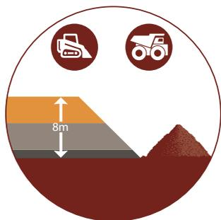
A bauxita é encontrada a cerca de oito metros de profundidade. Para extraí-la, é necessário remover a camada de argila da superfície com um trator. Em seguida, a camada de bauxita é escavada e transportada em caminhões para ser beneficiada. Após a lavra, a argila que foi retirada é devolvida ao local de origem e a área é preparada para o reflorestamento, realizado na época das chuvas.
